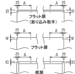
キッチンパネル取付け時の納まり(壁-壁納まりの時)
